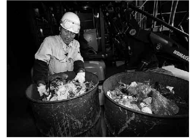
機械故障の原因となる金属類等の不適物を取り除く様子。
