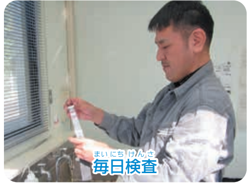
毎日検査 送り出す水道水に残留塩素があるかななどを毎日検査しています。
