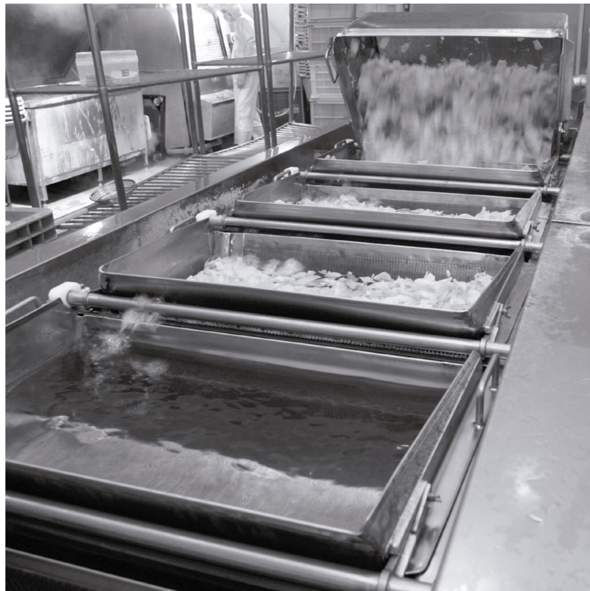
カット野菜などに使われる野菜を洗浄、殺菌、冷却を行う機械。6個のバケットが回転しながらレタスを移動させていきます。
