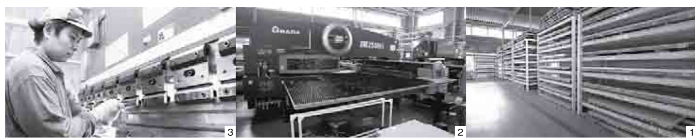
①工場に入るとすぐ、製品の元となるステンレスの板が私たちを迎えてくれました。用途にあった厚さを選び加工していきます。②ある程度の大きさにカットしたり穴をあける作業を行うこの機械。プログラム1つで動き、さまざまな形に仕上げます。③ステンレスを折り曲げる機械。曲げる角度に合わせて細かな調整が必要になります。
